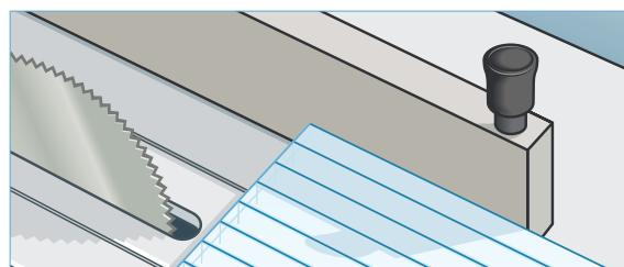
Ploče se mogu rezati cirkularnom pilom sa sitnim zupcima ili sa ručnom pilom pod plitkim nagibom.
