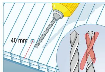
Rupe na pločama moraju biti veće od promjera kapice (vijka), odnosno min. Ø 18 mm. Uvijek ih bušiti između rebara, odnosno najmanje 40 mm od kraja ploče.
